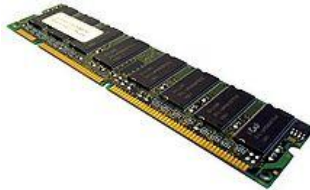
Moduł pamięci SDR SDRAM (3,3V, 168 pin)
