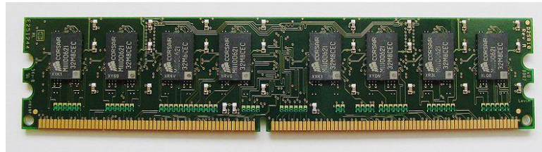
Moduł pamięci DDR2 SDRAM (1,8V, 240 pin)
