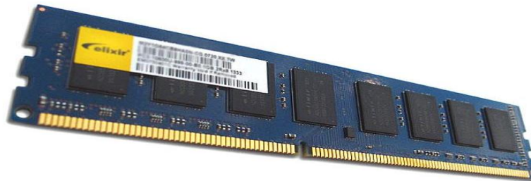
Modu pamięci DDR3 SDRAM (1,5V, 240 pin)
