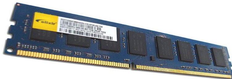
Modu pamięci DDR3 SDRAM (1,5V, 240 pin)
