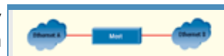
Rys. 2. Mosty przekazują ramki z jednej sieci do drugiej i są przezroczyste dla transmisji danych. Komunikujące się komputery nie mogą stwierdzić, że są podłączone do dwóch różnych sieci.
