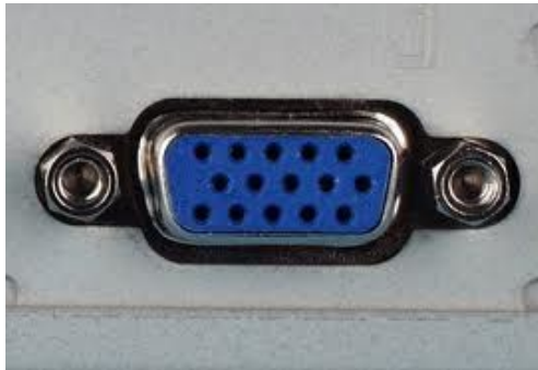
Złącze DSUB (15 pinów) - sygnał analogowy
