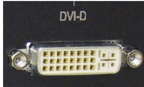
Złącze cyfrowe DVI (Digital Video Interface)
