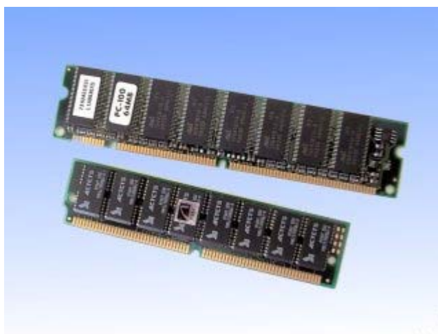
Rysunek 2.7. Porównanie pamięci typu SIMM i DIMM
