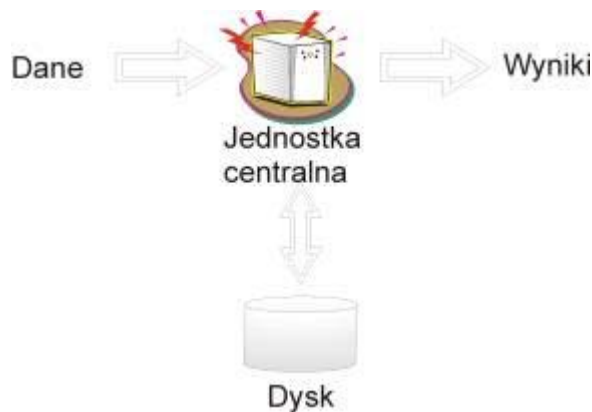
Rysunek 6. Mechanizm spoolingu
